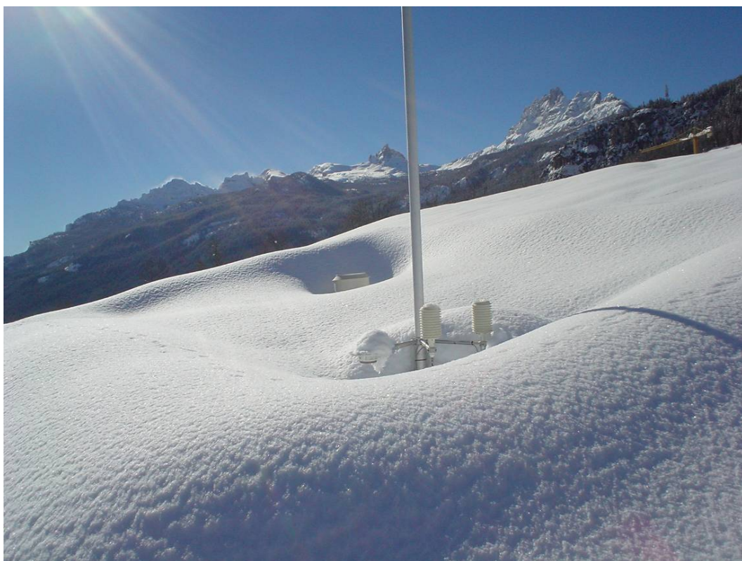
Fig. 33 - Stazione meteorologica di Cortina loc. Gilardon (1270 m s.l.m.)- Inverno 2013-2014. Si intravedono sia i sensori di temperatura, umidità relativa, e radiazione globale sia la bocca del pluviometro, tutti i sensori operano all'interno di avvallamenti del manto nevoso.
